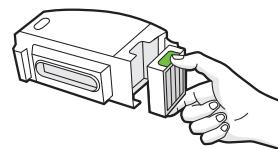
2 Nečistoty odstraňte poklepáním filtru o odpadkový koš.
