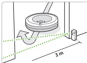
**Not:** Bu bariyer cihazdan uzaklaşıkça genişler (şekle bakın).
