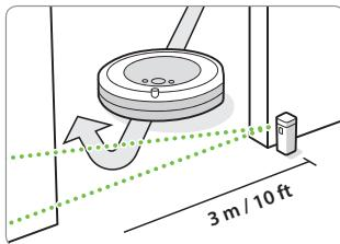
**Σημείωση:** Το πλάτος του φράγματος γίνεται μεγαλύτερο καθώς απομακρύνεται από τη συσκευή (ανατρέξτε στην εικόνα).
