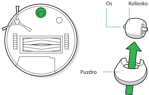
**Dôležité:** Zablokovanie predného kolieska nečistotami by mohlo mať za následok poškodenie podlahy. Ak sa koliesko ani po vycistení neotáča voľne, kontaktujte oddelenie starostlivosti o zákazníkov.
