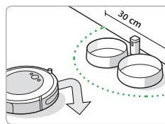
**Poznámka:** Pri bežnej prevádzke vydržia batérie 8 až 10 mesiacov. Ak nemáte v pláne dlhšiu dobu používať virtuálnu bariéru Virtual Wall, nezabudnite ju vypnúť, teda prepínač do strednej polohy.
