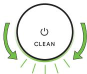
Amikor a robot érzékel, hogy a portartályt ki kell üríteni, a fénygyűrűs kijelző pirosan világít a hátsó rész felé irányuló törlő mozdulatokkal.
