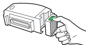
2 Vytraste nečistoty poklepaním filtra o smetný kôš.
